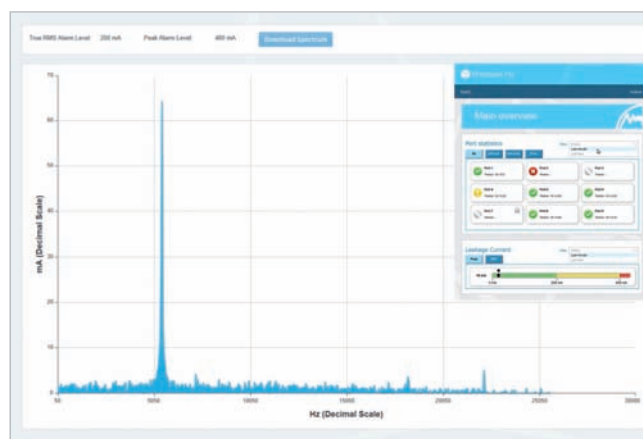
Obr. 4 Meranie prúdu v tienení integrované v prepínači
