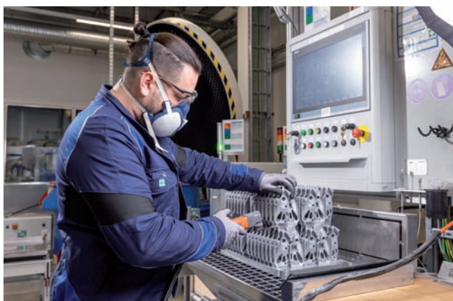
Výroba kovových komponentov pomocou selektívneho tavenia laserovým lúčom (Zdroj: BMW Group)
