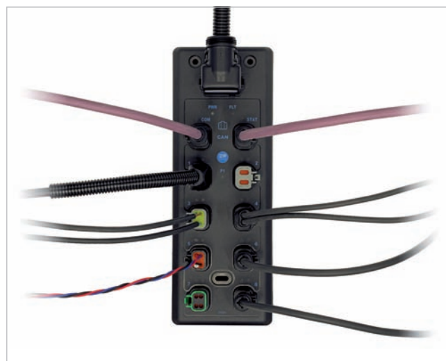
Aktívny modul polnej zbernice CANopen xtremeDB vytvára predpoklady na posun od káblového zväzku k decentralnému odolnému zásuvnému inštaláčnemu riešeniu.
