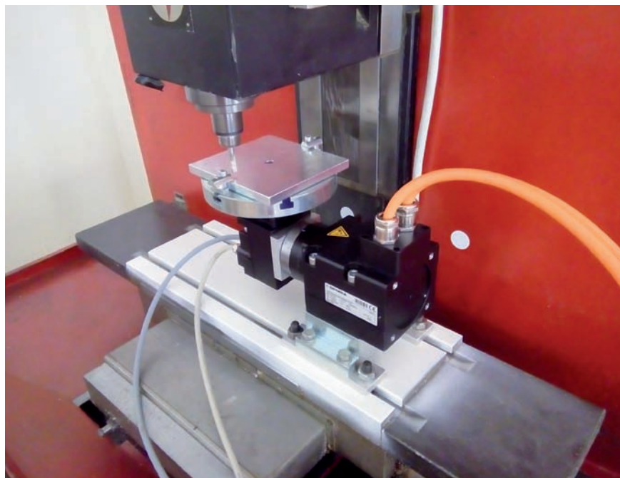
Overenie dvojosového polohovadla P2 s frézou CNC na pracovisku KVtAR TUKE
